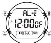
1. Verwenden Sie den Knopf (D) in dem Alarm-Modus, um durch die Alarmanzeigen zu scrollen, bis die gewünschte Anzeige erhalten wird, deren Zeit Sie einstellen möchten.
