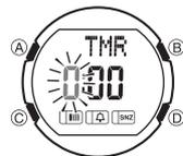
1. Halten Sie den Knopf (A) in dem Countdown-Timer-Modus gedrückt, bis die Stunden der Countdown-Startzeit zu blinken beginnen, wodurch die Einstellanzeige angezeigt wird.
