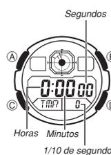
El temporizador de cuenta regresiva puede ajustarse dentro de una gama de 1 segundo a 24 horas. Una alarma suena cuando la cuenta regresiva llega a cero.
