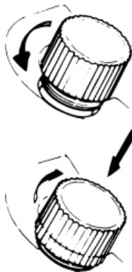
\* Avvitando la corona ruotarla lentamente e con attenzione, verificando che la vite si incastri con esattezza.
